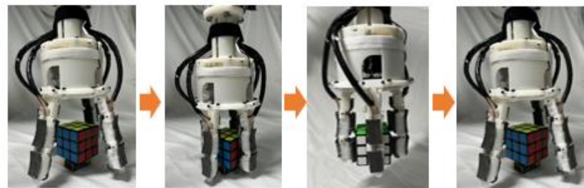
I. 接近物体 II. 夹紧物体 III. 举起物体 IV. 释放物体
